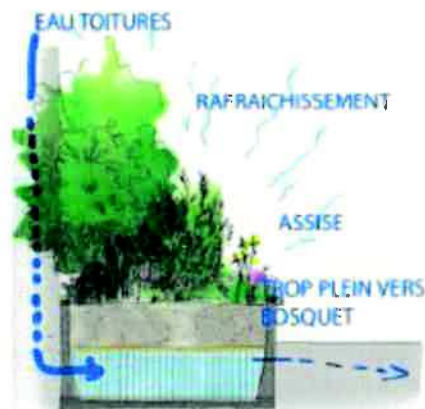
Figure 4: Coupe de principe des jardinières (source: dossier loi sur l'eau)
